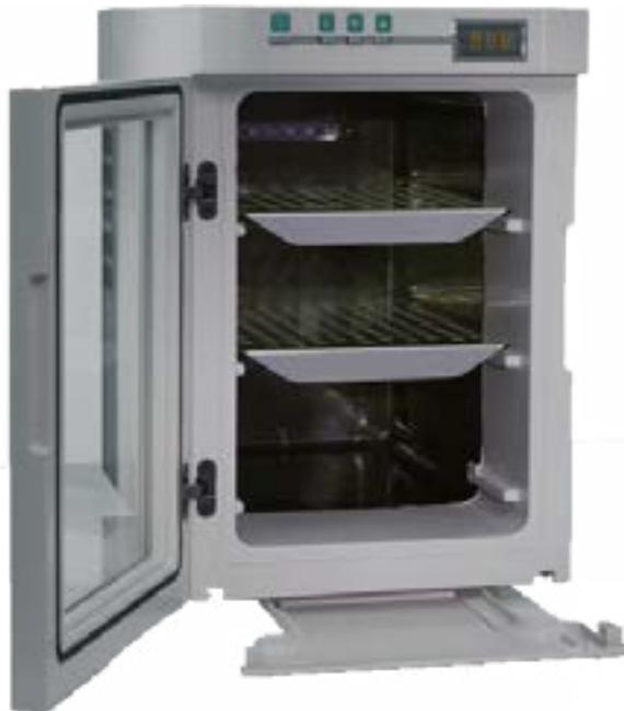
É um aparelho utilizado para a esterilização de materiais e instrumentais por meio de calor seco. Basicamente uma estufa deve conter um termômetro indicador da temperatura no interior da câmara; um termostato regulador da temperatura; uma lâmpada indicadora da condição de aquecimento ou da estabilização da temperatura interna da câmara. Quanto à circulação de ar no interior do aparelho, dois modelos estão disponíveis no mercado: o de convecção por gravidade e o de convecção mecânica.
